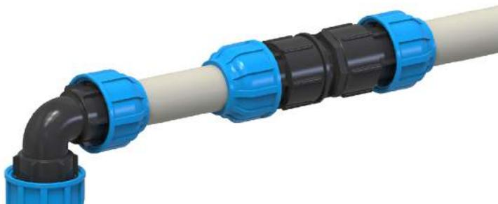
Используя компрессионные детали, можно создать разъемное соединение, которое в случае необходимости можно разобрать самостоятельно без особых усилий или применения дополнительного оборудования. Разбирать и собирать обратно такие стыки можно столько раз, сколько потребуется. При каждой сборке одного и того же соединения заменяют только уплотнители.
